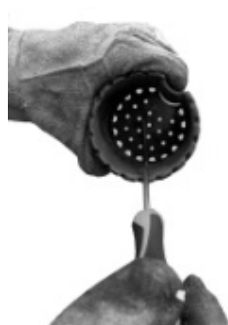
Fig. 34 - het schoonmaken van de vuurpot
