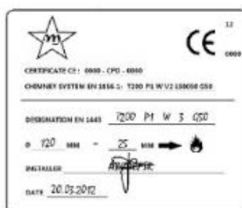
Fig. 4 - Voorbeeld van een plaatje
