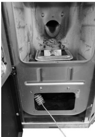
Fig. 74 - Reinig met pijpenwisser
