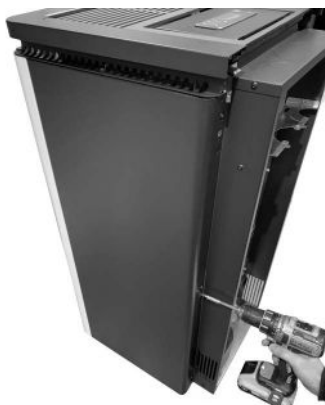
Fig. 31 - Achterste schroeven verwijderen
