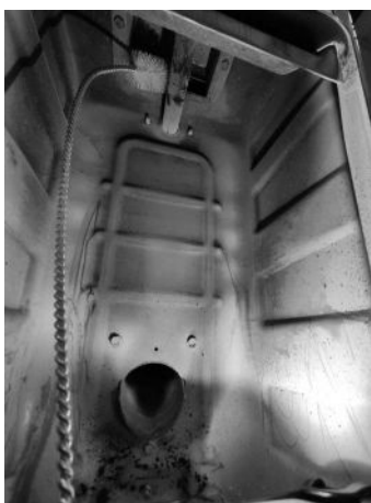
Fig. 76 - Reinig met pijpenwisser
