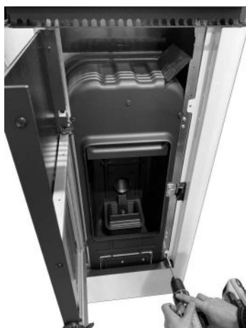
Fig. 33 - Voorste schroeven verwijderen
