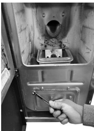
Fig. 72 - Verwijder de schroeven
