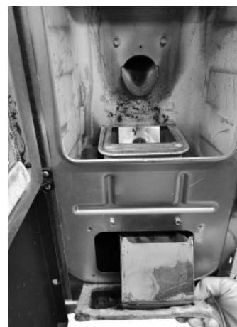
Fig. 73 - Verwijder de inspectiedop
