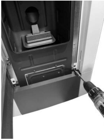
Fig. 35 - De schroeven verwijderen
