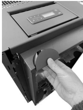
Fig. 58 - De dop verwijderen
