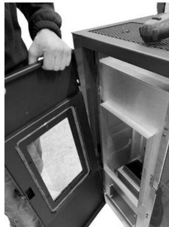
Fig. 24 - Verwijdering van de deur 3
