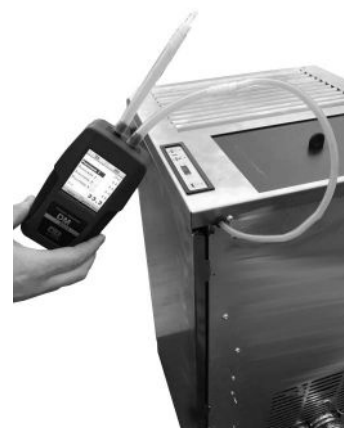
Fig. 70 - Aansluiting digitale drukregelaar
