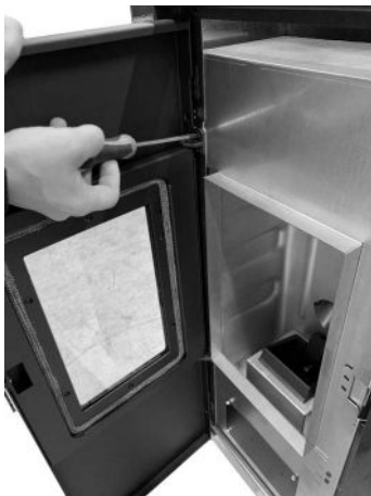
Fig. 22 - Verwijdering van de deur 1
