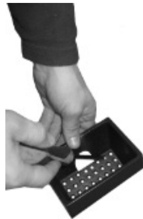
Fig. 34 - het schoonmaken van de vuurpot
