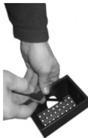
Fig. 34 - het schoonmaken van de vuurpot
