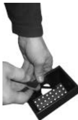
Fig. 34 - het schoonmaken van de vuurpot
