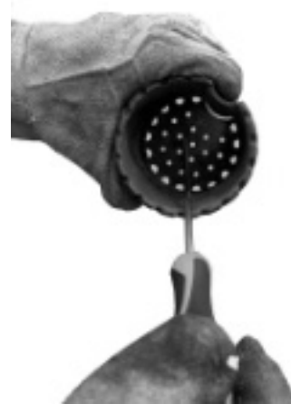
Fig. 32 - het schoonmaken van de vuurpot
